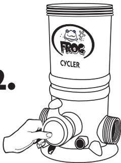
Gire el dial de control hacia delante y hacia atrás al extraerlo del cuerpo.
