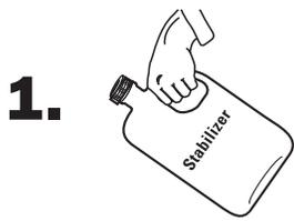
Si el nivel de estabilizador es menor que 20 ppm, agregue un estabilizador o acondicionador a la piscina al comenzar la temporada de uso. De esta manera evitará que el cloro se consuma. Siga las instrucciones del fabricante al pie de la letra.
