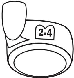
Después de cada prueba, ajuste el dial en incrementos de media posición si la lectura de cloro libre ha descendido a menos de 0,5 ppm, o en decrementos de media posición si la lectura ha ascendido a más de 1,0 ppm. Repita este proceso todos los días hasta la lectura de cloro libre se establezca
