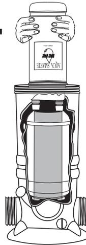
Alinee la pata pequeña de la unidad AQUA SMARTE® Bac Pac con la abertura pequeña del depósito de minerales AQUA SMARTE® y la pata grande con la abertura grande. Introduzca la unidad AQUA SMARTE® Bac Pac en el depósito de minerales AQUA SMARTE® hasta que quede firme.
