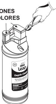
Apague la bomba. Gire el dial de control a 0. Abra la tapa de Infuzer. Retroceda para dejar que los vapores de cloro se disipen. Para quitar los tapones de colores, sujete el borde de un tapón con unas alicates y tire hacia arriba hasta que se libere el tapón. Repita el proceso con el otro tapón.
