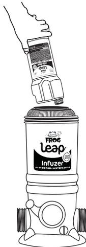
Insértelo boca abajo en el centro abierto del FROG Leap Anti-Bac Mineral Pac empujando hacia abajo firmemente en la botella FROG Leap All-Out para que la llave del FROG Leap Infuzer perforo el sello.
