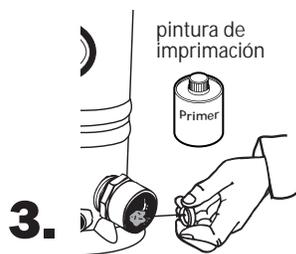
Siguiendo las instrucciones de la pintura de imprimación, aplíquela en el interior de los adaptadores y en los extremos de la tubería. Repita este proceso con cemento para PVC siguiendo las instrucciones del producto.
