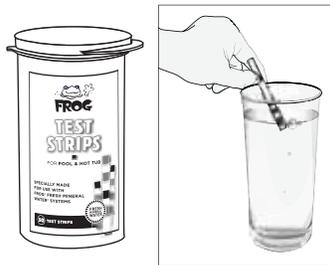
**5b.** Antes que nada, observe la lectura de **alcalinidad total**. Se deben hacer ajustes para que la alcalinidad total esté en un rango de entre **80 y 120 ppm** antes de realizar cualquier ajuste al pH, incluso si el pH aumenta más.
