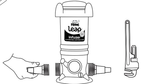
2. Enrosque los adaptadores en los extremos del FROG Leap Infuzer. Ajuste a mano. Termine de ajustar al darle 1 o 2 giros con una llave de tubo. **NO AJUSTE EXCESIVAMENTE.**
