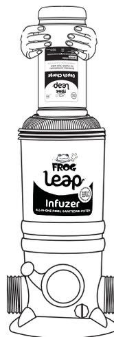
Alinee la pata pequeña de la unidad FROG Leap Depth Charge o Reveille con la abertura pequeña del FROG Leap Anti-Bac Mineral Pac y la pata grande con la abertura grande. Introduzca la unidad FROG Leap Depth Charge o Reveille hasta que quede firme.
