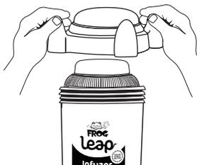
Apague la bomba. Gire el dial de control a 0. Retire la tapa del FROG Leap Infuzer y aléjese mientras se disipa el gas del cloro.
