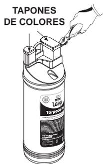
Para quitar los tapones de colores de la unidad FROG Leap Torpedo Pac, sujete el borde de un tapón con un alicate y tire hacia arriba hasta que se libere el tapón. Repita el proceso con el otro tapón.
