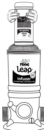
Alinee la pata pequeña de la unidad FROG Leap Torpedo Pac con la abertura pequeña del FROG Leap Anti-Bac Mineral Pac y la pata grande con la abertura grande. Introduzca la unidad FROG Leap Torpedo Pac en el FROG Leap Anti-Bac Mineral Pac hasta que quede firme.
