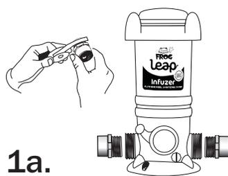
Si usa **adaptadores macho**, aplique cinta de teflón para tubería o sellador en el extremo roscado de cada adaptador.
