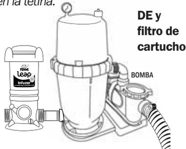
**4.** Aplique sellador o cinta para tuberías roscadas en el extremo roscado del adaptador de manguera.
