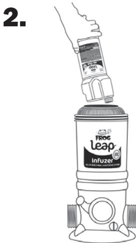
Insértelo boca abajo en el centro abierto del FROG Leap Anti-Bac Mineral Pac empujando hacia abajo firmemente en la botella FROG Leap All-Out para que la llave del FROG Leap Infuzer perforo el sello.
