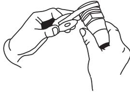
2. Enrosque los adaptadores en los extremos del FROG Leap Infuzer. Ajuste a mano. Termine de ajustar al darle 1 o 2 giros con una llave tubo. **NO AJUSTE EXCESIVAMENTE.**
