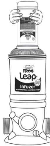
Alinee la pata pequeña de la unidad FROG Leap Torpedo Pac con la abertura pequeña del FROG Leap Anti-Bac Mineral Pac y la pata grande con la abertura grande. Introduzca la unidad FROG Leap Torpedo Pac en el FROG Leap Anti-Bac Mineral Pac hasta que quede firme.
