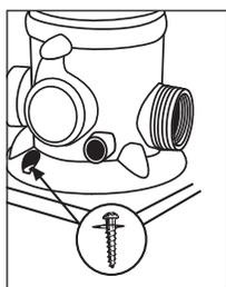
Para mayor estabilidad, el FROG Leap Infuzer puede montarse sobre una base de madera tratada utilizando **tornillos de cabeza Phillips plana**, uno en el frente y dos atrás.
