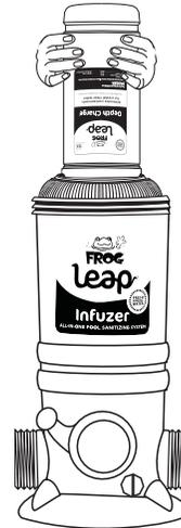
Alinee la pata pequeña de la unidad FROG Leap Depth Charge o Reveille con la abertura pequeña del FROG Leap Anti-Bac Mineral Pac y la pata grande con la abertura grande. Introduzca la unidad FROG Leap Depth Charge o Reveille hasta que quede firme.
