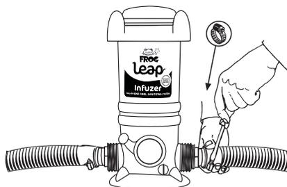
4. Para evitar daños a los calentadores o filtros, instale una **válvula de retención resistente a la corrosión** que reduzca el flujo de retorno de cloro gaseoso cuando el Infuzer esté apagado.
