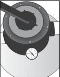
Revise el filtro de la piscina con frecuencia y límpiolo periódicamente siguiendo las instrucciones del fabricante. Un filtro sucio reducirá la velocidad del flujo de agua, lo que puede obstaculizar la circulación adecuada.
