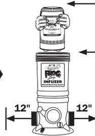
Deje un mínimo de 12 pulgadas arriba y a cada lado del FROG Leap Infuzer para asegurar que haya espacio para reemplazar fácilmente el FROG Leap Anti-Bac Mineral Pac y el FROG Leap Torpedo Pac.
