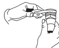
**5.** Enrosque el adaptador en el otro costado del FROG Leap Infuser. Ajuste a mano. Termine de ajustar al darle 1 o 2 giros con una llave de tubo. **NO AJUSTE EXCESIVAMENTE.**
