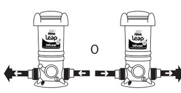
El diseño de la válvula de flujo doble permite la instalación en cualquier dirección de flujo.
