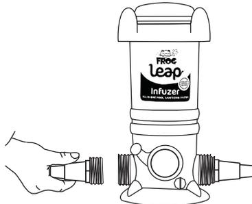
3. Una el tramo de filtro de la manguera flexible a un adaptador para manguera y el tramo de retorno de la manguera flexible al otro adaptador para manguera. Use las abrazaderas y ajuste con un destornillador. La válvula bidireccional permite el flujo del agua en ambas direcciones.
