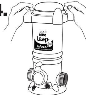
Vuelva a colocar el tapón y ajuste únicamente a mano. **NO AJUSTE EXCESIVAMENTE.**
