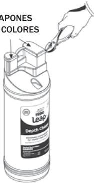
Apague la bomba. Gire el dial de control a 0. Abra la tapa de Infuzer. Retroceda para dejar que los vapores de cloro se disipen. Para quitar los tapones de colores, sujete el borde de un tapón con unas alicates y tire hacia arriba hasta que se libere el tapón. Repita el proceso con el otro tapón.
