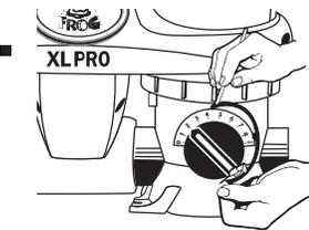
Con un destornillador pequeño o con una herramienta con punta que funcione de guía, asegúrese de que el anillo de resorte se mantenga en la ranura mientras lo inserta.
