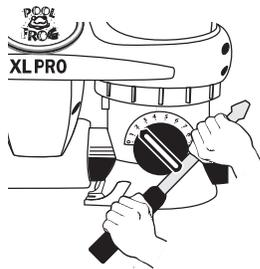
Con un destornillador grande, afloje el dial de control. Con cuidado, haga palanca para levantar el dial hasta que salga.
