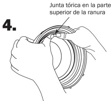
Haga rodar los pulgares hacia adelante y hacia atrás sobre la junta tórica mientras empuja hacia arriba hasta que la junta tórica entre en la parte superior de la ranura.
