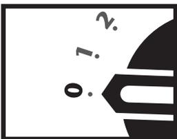
Apague la bomba y gire el dial a la posición 0 sobre el Pool FROG XL PRO Mineral Cycler. Con esto se reduce el flujo de agua a la unidad al abrir la tapa.
