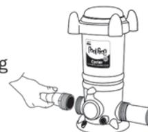
**6.** Conecte el tramo de retorno de la manguera al adaptador con la abrazadera. Ajuste la abrazadera con un destornillador.
