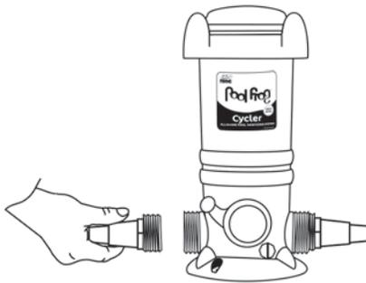
3. Una el tramo de filtro de la manguera flexible a un adaptador para manguera y el tramo de retorno de la manguera flexible al otro adaptador para manguera. Use las abrazaderas y ajuste con un destornillador. La válvula bidireccional permite el flujo del agua en ambas direcciones.
