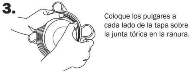
Coloque los pulgares a cada lado de la tapa sobre la junta tórica en la ranura.
