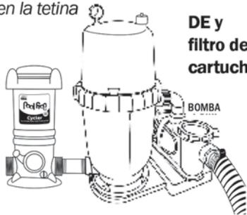
**4.** Aplique sellador o cinta para tuberías roscadas en el extremo roscado del adaptador de manguera.
