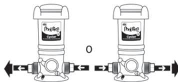
El diseño de la válvula de flujo doble permite la instalación en cualquier dirección de flujo.
