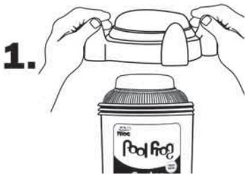
1. Apague la bomba. Gire el dial de control a 0. Retire la tapa del Pool FROG Cyclor y aléjese mientras se disipa el gas del cloro.
