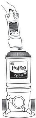
Apague la bomba. Gire el dial de control a 0. Abra la tapa del Cyclor. Retroceda para dejar que los vapores de cloro se disipen. Insértelo boca abajo en el centro abierto del POOL FROG Mineral Reservoir empujando hacia abajo firmemente en la botella FROG BAM para que la llave del Pool FROG Cyclor perfore el sello.
