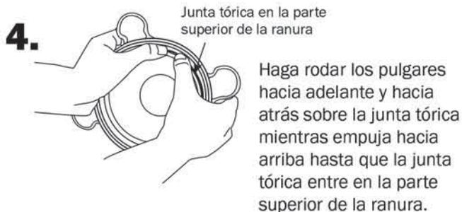
Haga rodar los pulgares hacia adelante y hacia atrás sobre la junta tórica mientras empuja hacia arriba hasta que la junta tórica entre en la parte superior de la ranura.
