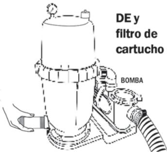
**3.** Enrosque un costado del Pool FROG Cycler al extremo abierto del manguito hasta que quede vertical y firme.
