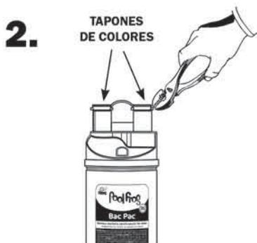
2. Para quitar los tapones de colores de la unidad POOL FROG Bac Pac, sujete el borde de un tapón con un alicate y tire hacia arriba hasta que se libere el tapón. Repita el proceso con el otro tapón.
