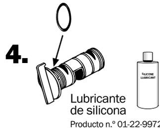
4. Reemplace cuidadosamente la junta tórica de caucho sin estirarla. Aplique el lubricante de silicona que se entregó con el New Water Cykler en la junta tórica.
