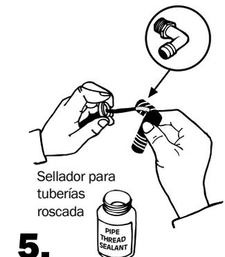
**5.** Siga las instrucciones del sellador para tuberías roscadas y aplíquelo sobre la rosca del codo.
