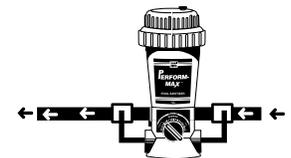
NO instale el Perform-Max Feeder 960, con conexión, ya que este Perform-Max Feeder es diferente a una unidad con conexión.
