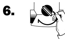
6. Inserte el extremo sin borde del anillo de resorte dentro de la apertura de la ranura desde la posición 5 en punto y empújelo para que se enrosque alrededor del dial de control.
