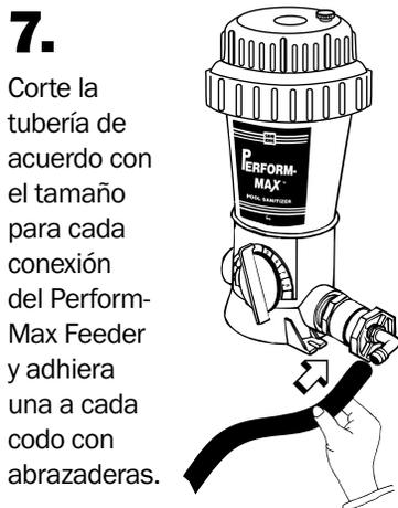
7. Corte la tubería de acuerdo con el tamaño para cada conexión del Perform-Max Feeder y adhiera una a cada codo con abrazaderas.
