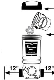
12" Deje un mínimo de 12 pulgadas arriba y a cada lado del Perform-Max Feeder para asegurarse de que exista espacio para la colocación fácil de químicos
