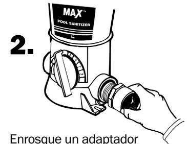
**2.** Enrosque un adaptador macho en cada puerto del Perform-Max Feeder y ajuste manualmente. Termine el ajuste girando de 1 a 2 revoluciones con una llave para tubo. **NO AJUSTE DEMASIADO.**
