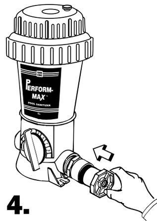
**4.** Inserte el buje reductor dentro del adaptador macho en ambos lados con una acción de torsión. Mantenga presionado de 5 a 10 segundos para que se adhiera.
