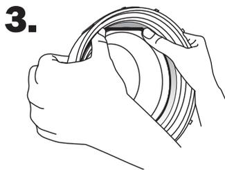
Coloque los pulgares a cada lado de la tapa sobre la junta tórica en la ranura.
