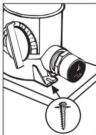
Para mayor estabilidad, el POOL FROG XL PRO Cyclers puede montarse sobre una base de madera tratada utilizando **torillos de cabeza Phillips plana**, uno en el frente y dos atrás.
