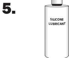
Lubrique la junta tórica con frecuencia, utilizando el lubricante de silicona entregado con el POOL FROG XL Pro Cyclers.
