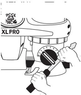
3. Con un destornillador grande, afloje el dial de control. Con cuidado, haga palanca para levantar el dial hasta que salga.
