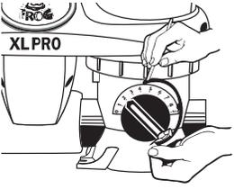
7. Con un destornillador pequeño o con una herramienta con punta que funcione de guía, asegúrese de que el anillo de resorte se mantenga en la ranura mientras lo inserta.
