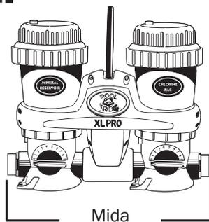
Mida la distancia entre los adaptadores exteriores y recorte una sección de tubo 3" menor a esa dimensión.
