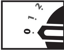
Apague la bomba. Coloque el dial en 0. Esto reduce el flujo de agua del interior de la unidad cuando la tapa está abierta.
