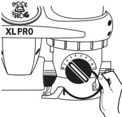
6. Inserte el extremo sin borde del anillo de resorte dentro de la apertura de la ranura desde la posición 5 en punto y empújelo para que se enrosque alrededor del dial de control.
