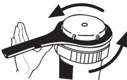
Abra la tapa. Use la herramienta para tapa incluida con el Cyclers para aflojarla golpeando el mango con la palma de la mano en el sentido contrario a las agujas del reloj. Retroceda para permitir que se disipen los gases de cloro.
