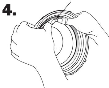
Haga rodar los pulgares hacia adelante y hacia atrás sobre la junta tórica mientras empuja hacia arriba hasta que la junta tórica entre en la parte superior de la ranura.
