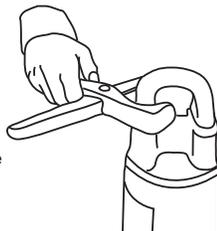
3B. Coloque la sección curvada de la herramienta alrededor del extremo angosto de una torre de pac y alinee la hoja en la hendidura.
