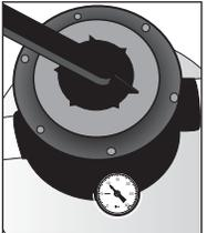
Revise el filtro de la piscina con frecuencia y límpielo periódicamente siguiendo las instrucciones del fabricante. Un filtro sucio reducirá la velocidad del flujo de agua, lo que puede obstaculizar la circulación adecuada.
