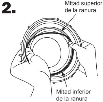
Coloque una nueva junta tórica en la mitad inferior de la ranura.
