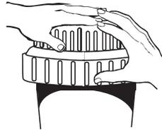
Vuelva a colocar el tapón y ajuste únicamente a mano. **NO AJUSTE EXCESIVAMENTE. NO UTILICE LA HERRAMIENTA PARA TAPA PARA EL APRETAR. SOLO ÚSELA PARA QUITAR LA TAPA.**
