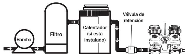
Para evitar daños a los calentadores o filtros, instale una **válvula de retención resistente a la corrosión** que reduzca el flujo de retorno de cloro gaseoso cuando los Cyclers están apagados.
