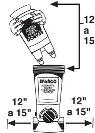
Deje un mínimo de 12 pulgadas arriba y a cada lado del Sparco System para asegurar que haya espacio para reemplazar fácilmente el Sparco Chamber.
