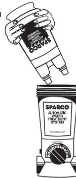
Inserte el Sparco Chamber dentro del Sparco System, alineando las aberturas en el Sparco Chamber con llaves en Sparco System.
