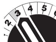
Después de la prueba, ajuste el dial 1/2 punto más si la lectura de cloro libre ha disminuido o 1/2 punto menos si la lectura ha aumentado. Continúe con este proceso todos los días hasta que el color en la tira reactiva coincida con el nivel ideal de de entre 1.0 ppm y 3.0 ppm de cloro.
