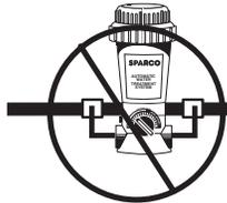
NO instale el Sparco System, sin conexión.
