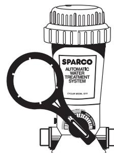
**Recuerde ajustar el dial de control 1/2 punto sólo con el fin de impedir el exceso de cloración que puede decolorar las superficies de la piscina. Use la punta del mango de la tapa si se complica girar el dial.**
