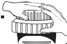
Vuelva a colocar el tapón y ajuste únicamente a mano.
