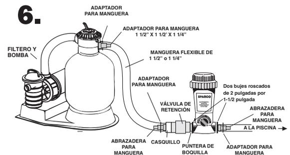
Para evitar daños a los calentadores o filtros, instale una **válvula de retención resistente a la corrosión** que reduzca el flujo de retorno de cloro gaseoso cuando el Sparco System esté apagado.
