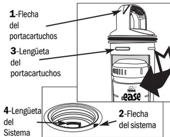
Inserte el portacartuchos lentamente en el sistema (vea los diagramas). Alinee la flecha del portacartuchos (1) con la flecha del sistema (2). Empuje hacia abajo hasta que las lengüetas del portacartuchos (3) rebasen las lengüetas del sistema (4) gire el portacartuchos hacia la derecha (en sentido de las manecillas) hasta que se detenga. Para asegurar que esté en la posición enganchada, intente tirar del portacartuchos hacia arriba. Si se mantiene en su sitio, el enganche es seguro.
