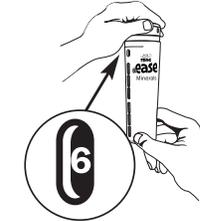
**Ajuste el FROG @ease Mineral Cartridge (azul)** en el n°. 6 (sostenga la parte inferior y gire la parte superior hasta que aparezca 6 en la ventana de ajuste). No es necesario realizar ajustes adicionales durante la vida útil de este cartucho.
