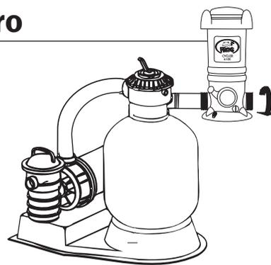
**3.** Enrosque un costado del POOL FROG Cycler al extremo abierto del manguito hasta que quede vertical y firme.
