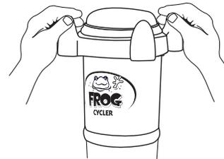
Vuelva a colocar el tapón y ajuste únicamente a mano. **NO AJUSTE EXCESIVAMENTE.**
