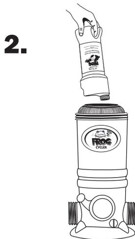
Apague la bomba. Gire el dial de control a 0. Abra la tapa del Cycler. Retroceda para dejar que los vapores de cloro se disipen. Insértelo boca abajo en el centro abierto del POOL FROG Mineral Reservoir empujando hacia abajo firmemente en la botella FROG BAM para que la llave del POOL FROG Cycler perfora el sello.
