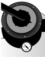
**2.** Revise el medidor del filtro de la piscina con frecuencia y limpie el filtro de manera periódica, conforme a las instrucciones del fabricante. Un filtro sucio reducirá el flujo de agua, lo cual puede afectar la circulación.
