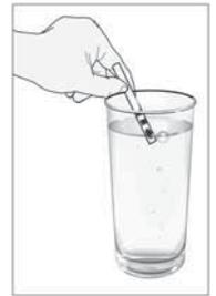
**5b.** Antes que nada, observe la lectura de **alcalinidad total**. Se deben hacer ajustes para que la alcalinidad total esté en un rango de entre **80 y 120 ppm** antes de realizar cualquier ajuste al pH, incluso si el pH aumenta más.
