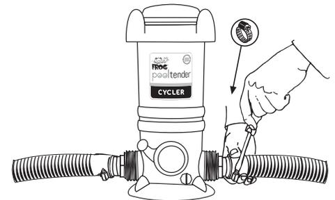
**4.** Para evitar daños a los calentadores o filtros, instale una **válvula de retención resistente a la corrosión** que reduzca el flujo de retorno de cloro gaseoso cuando el Cycler esté apagado.
