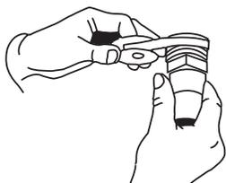
**5.** Enrosque el adaptador en el otro costado del FROG Pool Tender Cyclor. Ajuste a mano. Termine de ajustar al darle 1 o 2 giros con una llave de tubo. **NO AJUSTE EXCESIVAMENTE.**
