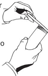
**2.** Enrosque un extremo del manguito en el punto de retorno del filtro. Ajuste a mano. Termine de ajustar al darle 1 o 2 giros con una llave. **NO AJUSTE EXCESIVAMENTE.**
