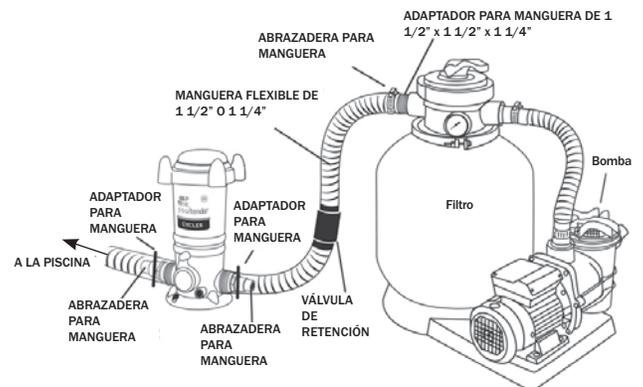
**5.** Para mayor estabilidad, el FROG Pool Tender Cycler puede montarse sobre una base de madera tratada utilizando  **tornillos de cabeza Phillips plana**, uno en el frente y dos atrás.
