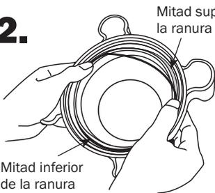
Coloque una nueva junta en la mitad inferior de la ranura.
