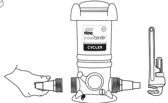
**1.** Aplique sellador o cinta para tuberías roscadas en el extremo roscado de ambos adaptadores para mangueras.
