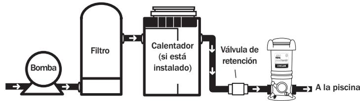
El FROG Pool Tender Cyclers debe instalarse siempre entre el filtro y la piscina (o entre el calentador y la piscina, si corresponde). Nunca instale el FROG Pool Tender Cyclers antes de haber instalado el calentador, porque podría sufrir daños.
