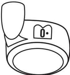
Apague la bomba y gire el dial a la posición 0. Con esto se reduce el flujo de agua a la unidad al abrir la tapa.
