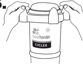
Vuelva a colocar el tapón y ajuste únicamente a mano. **NO AJUSTE EXCESIVAMENTE.**
