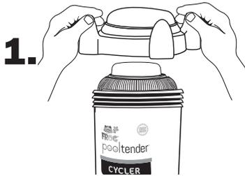
**1.** Apague la bomba. Gire el dial de control a 0. Retire la tapa del FROG Pool Tender Cyclor y aléjese mientras se disipa el gas del cloro.
