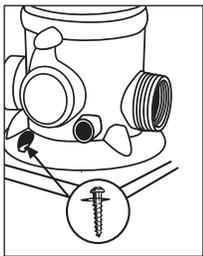
Para mayor estabilidad, el FROG Pool Tender Cyclers puede montarse sobre una base de madera tratada utilizando **tornillos de cabeza Phillips plana**, uno en el frente y dos atrás.
