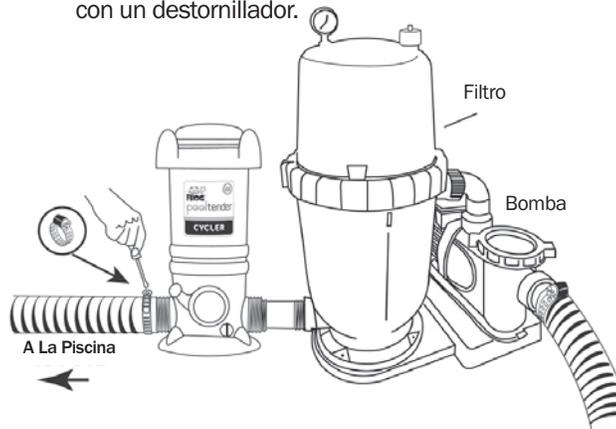
**7.** Para mayor estabilidad, el FROG Pool Tender Cyclor puede montarse sobre una base de madera tratada utilizando **tuercas de cabeza Phillips plana**, uno en el frente y dos atrás. Si tiene preguntas sobre la estabilidad, comuníquese con su distribuidor o con King Technology.
