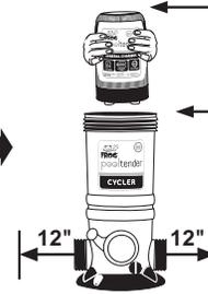
Deje un mínimo de 12 pulgadas arriba y 12" a cada lado del FROG Pool Tender Cyclers para asegurar que haya espacio para reemplazar fácilmente el FROG Pool Tender Mineral Chamber y el FROG Pool Tender Chlorine Chamber.
