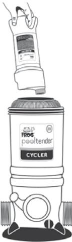
Insértelo boca abajo en el centro abierto del FROG Pool Tender Mineral Chamber empujando hacia abajo firmemente en la botella FROG Pool Tender Algaecide para que la llave del FROG Pool Tender Cyclor perforo el sello.
