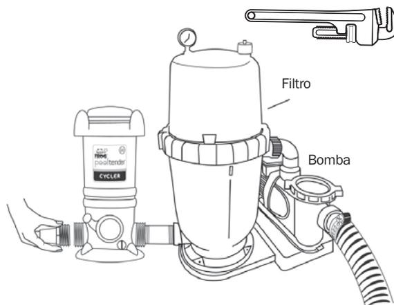
**6.** Conecte el tramo de retorno de la manguera al adaptador con la abrazadera. Ajuste la abrazadera con un destornillador.
