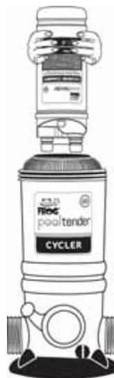
Si el FROG Pool Tender Chlorine Chamber aún contiene cloro, envuélvalo con una bolsa de plástico y guárdelo en un cobertizo o en un ambiente fresco, seco, bien ventilado, fuera del alcance de niños, mascotas, automóviles, motocicletas o cualquier metal que pueda oxidarse, etc.
