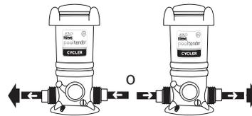
El diseño de la válvula de flujo doble permite la instalación en cualquier dirección de flujo.
