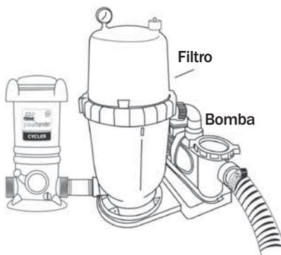
**4.** Aplique sellador o cinta para tuberías roscadas en el extremo roscado del adaptador de manguera.
