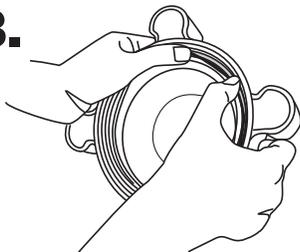
Coloque los pulgares a cada lado de la tapa sobre la junta tórica en la ranura.
