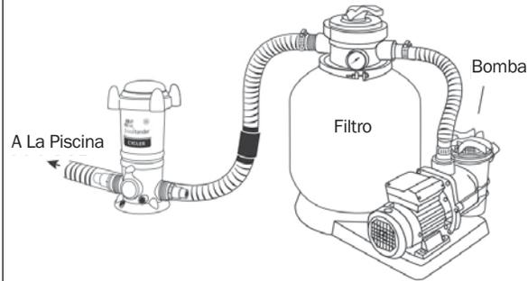
El FROG Pool Tender Cycler debe instalarse siempre entre el filtro y la piscina (o entre el calentador y la piscina, si corresponde). Nunca instale el FROG Pool Tender Cycler antes de haber instalado el calentador, porque podría sufrir daños.
